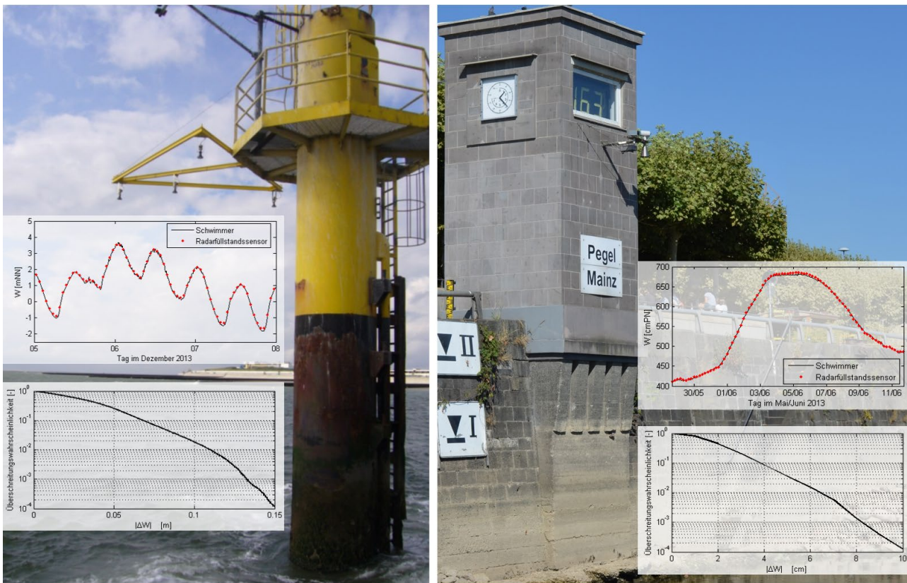
Abbildung 1: Vergleichsmessungen von Radarfüllstandsensor und Schwimmerpegel in Küsten- und Binnengewässern (links: Pegel Borkum-Südstrand, rechts: Pegel Mainz)
